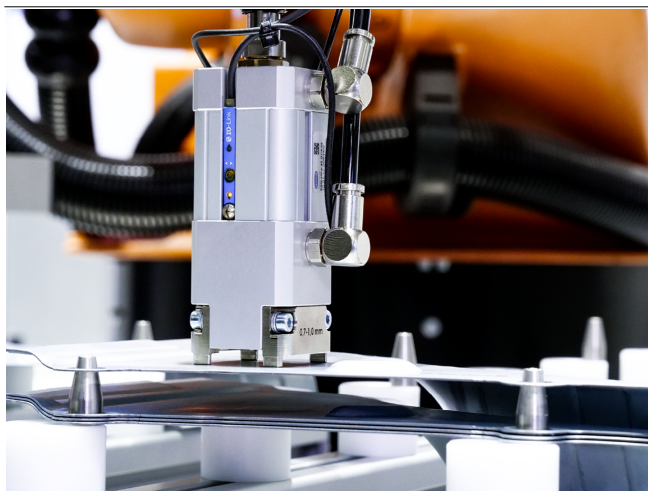
Магнитный захват SGM-HPm для перемещения тонкого листового материала
